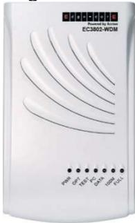
Achtung – dieses Gerät ist auf eine Bandbreite von 100Mbit/s limitiert. Sollte ein Tarifpaket mit höherer Bandbreite gewünscht werden, muss der Wandler ausgetauscht werden.
